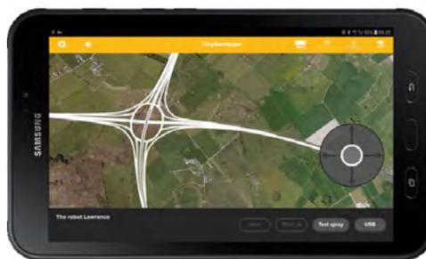
La tablette fournie avec le robot donne à l'opérateur le contrôle total du robot ainsi que des paramètres de chaque tâche. L'opérateur peut par exemple ajuster les paramètres de marquage, appliquer des décalages de projection et régler les vitesses du robot directement à partir de la tablette.
